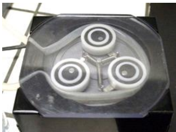
Pompe péristaltique avec système à galets.
